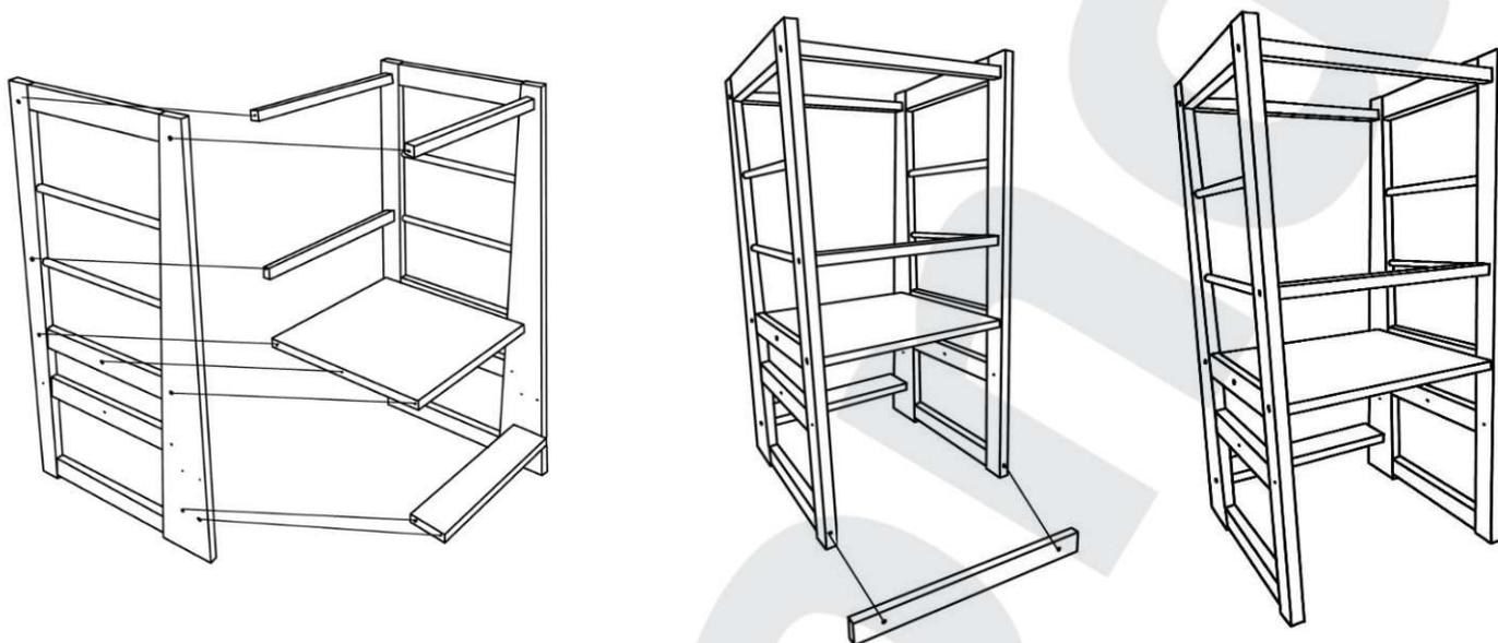
1. Aby bolo možné nábytok správne zostaviť, musia byť všetky jeho komponenty spojené pomocou skrutiek, ktoré sú súčasťou balenia. **Ak niektorý komponent chýba, môže ovplyvniť stabilitu konštrukcie a ohroziť bezpečnosť dieťaťa!**
